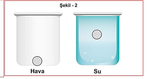
Demir bilyeler bırakıldıktan sonra ilk bilyenin kabın dibine değme anı
