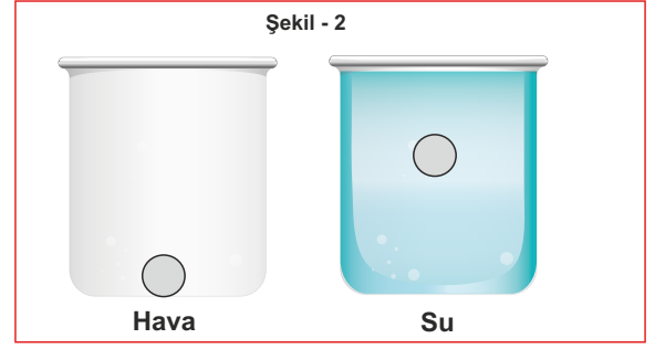
Demir bilyeler bırakıldıktan sonra ilk bilyenin kabın dibine değme anı
