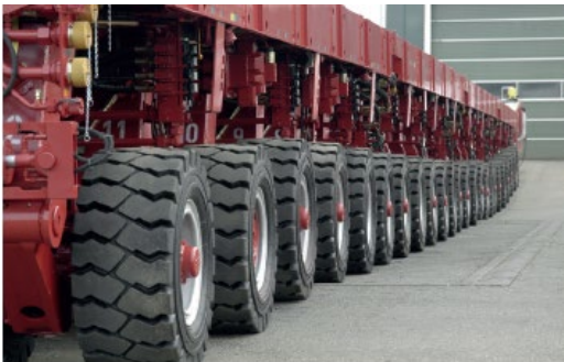
Şekil 2: Artuklu Hamamı'nın taşınmasında kullanılan araçların tekerlekleri
