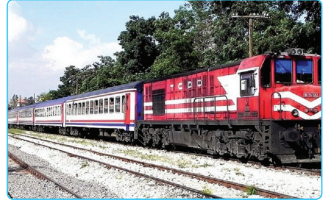
Tren raylarında bozulmalar olmaması için, trenlerdeki tekerlek sayısının fazla olması
