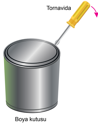
Şekil 2: Boya kutusunun kapağı tornavida ile açılıyor.
