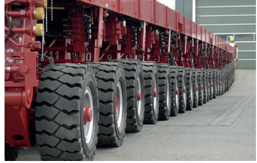
Şekil 2: Artuklu Hamamı'nın taşınmasında kullanılan araçların tekerlekleri
