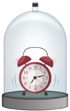
Havası boşaltılmış fanus Çalar saat duyulmaz
